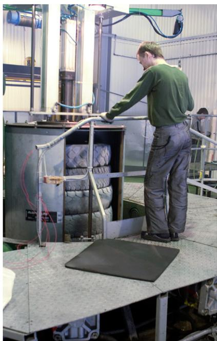
**Установка заряда, подрыв: были покрышки — стала крошка**
