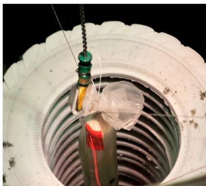
**После часа в криокамере пакет покрышек поступает во взрывоциркулятор**
