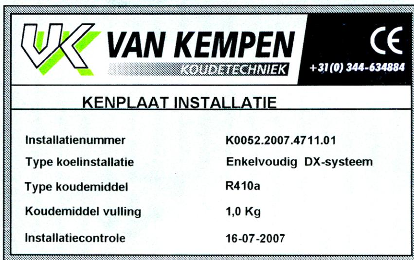
Образец наклейки, которая размещается на монтируемом оборудовании
