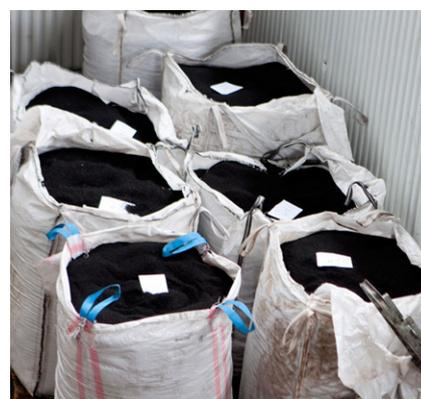
**Окончательный продукт переработки покрышек — крошка, которая сортируется по размеру**
