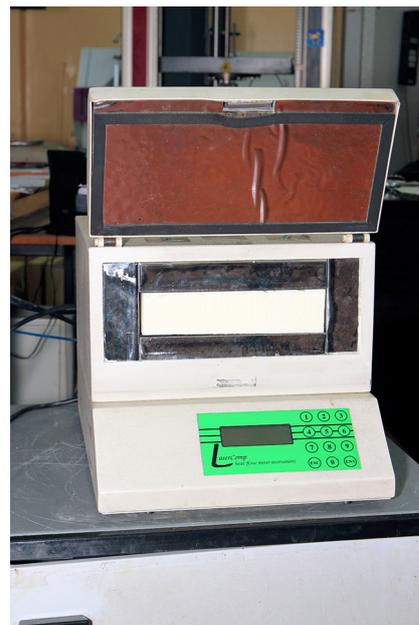
**Оборудование для проведения исследований и тестирования. Прибор для определения коэффициента теплопроводности ППУ**
