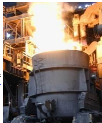
Рис.8. Оборудование литейно-прокатного завода в г.Ярцево: < а) прокатка строительной арматуры; б) выпуск стали из дуговой печи >
