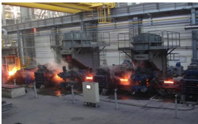
Рис.8. Оборудование литейно-прокатного завода в г.Ярцево: < а) прокатка строительной арматуры; б) выпуск стали из дуговой печи >
